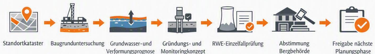
Abbildung 14: Empfohlener Ablauf der weiteren Einzelfallprüfung von Standortkataster bis zur Abstimmung mit RWE und Bergbehörde.
