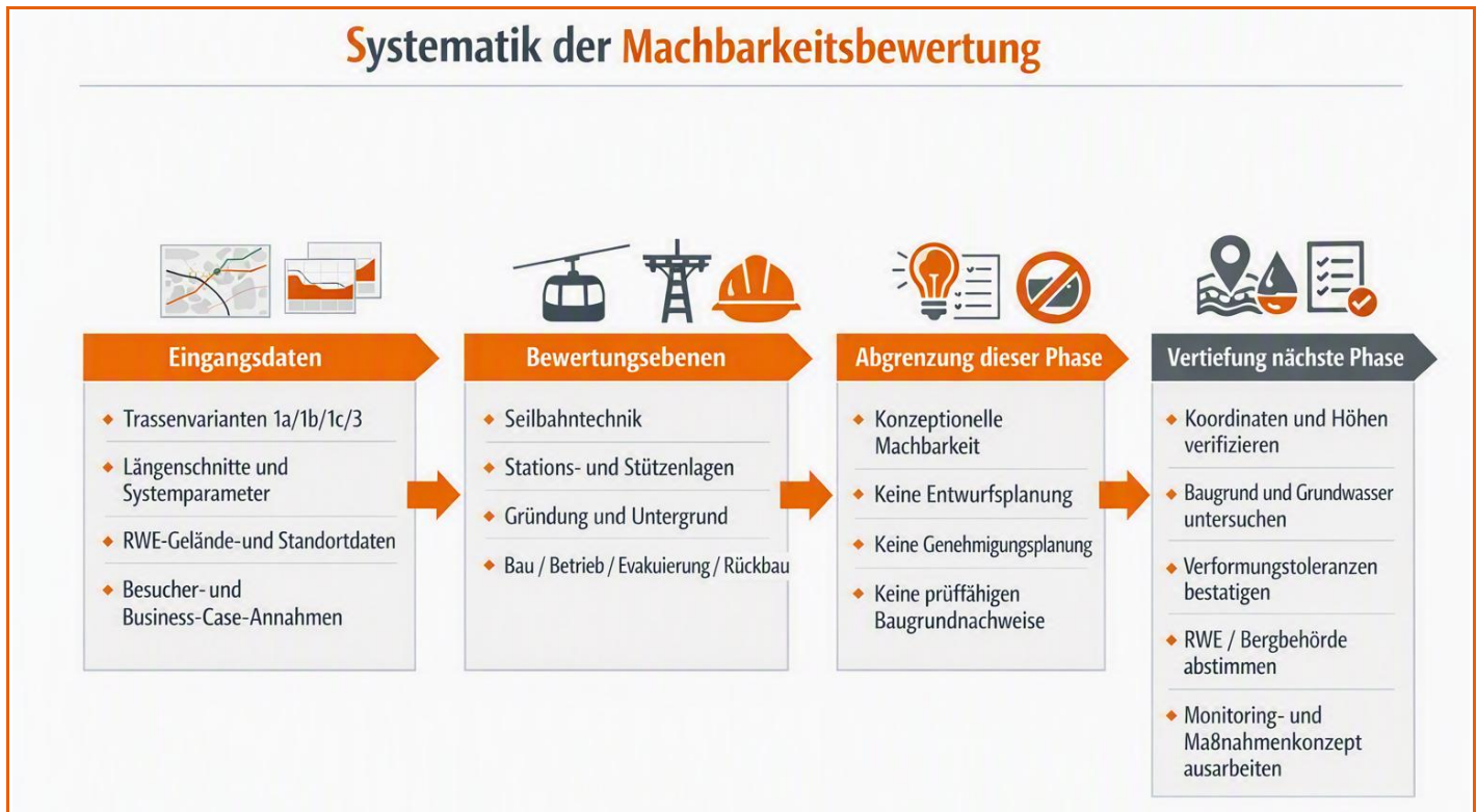
Abbildung 9: Systematik der Machbarkeitsbewertung mit Eingangsdaten, Bewertungsebenen, Abgrenzung dieser Phase und Vertiefungsbedarf für die nächste Projektphase.
